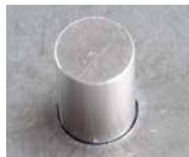
Furo de 12 mm cortado a plasma com tecnologia True Hole pela HPRXD
