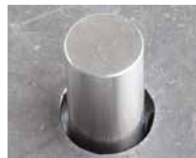
Furo de 12 mm cortado a plasma sem tecnologia True Hole pela HPRXD
