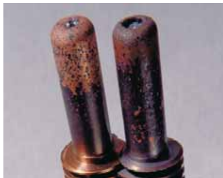
Eletrodo após uso normal, eletrodo após uso excessivo
