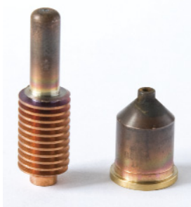
Eletrodo e bico parcialmente usados
