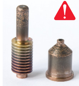
Hora de trocar eletrodo e bico
