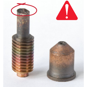
Eletrodo e bico excessivamente usados
