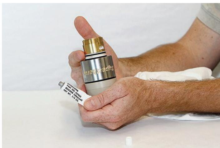
e os anéis retentores das conexões e do suporte da tocha.
